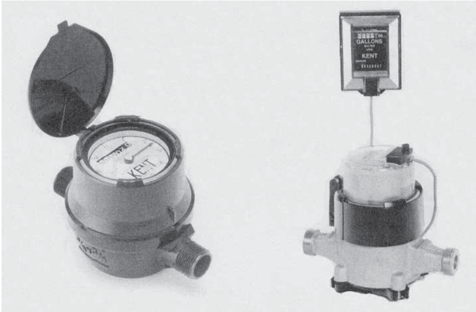
شكل 4-25: عداد مياه منزلي مع قرص متأرجح ينقل إشارة العد إلى مسجل عبر بيانات مغناطيسية. يمكن للعداد أن يوصل بمسجل عن بعد مركب خارج البيت (موافقة Kent Meters Co)
